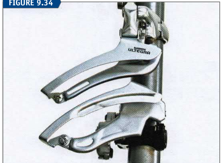
Top: shallow cage derailleur; Bottom: deep cage derailleur
