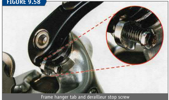
Frame hanger tab and derailleur stop screw
